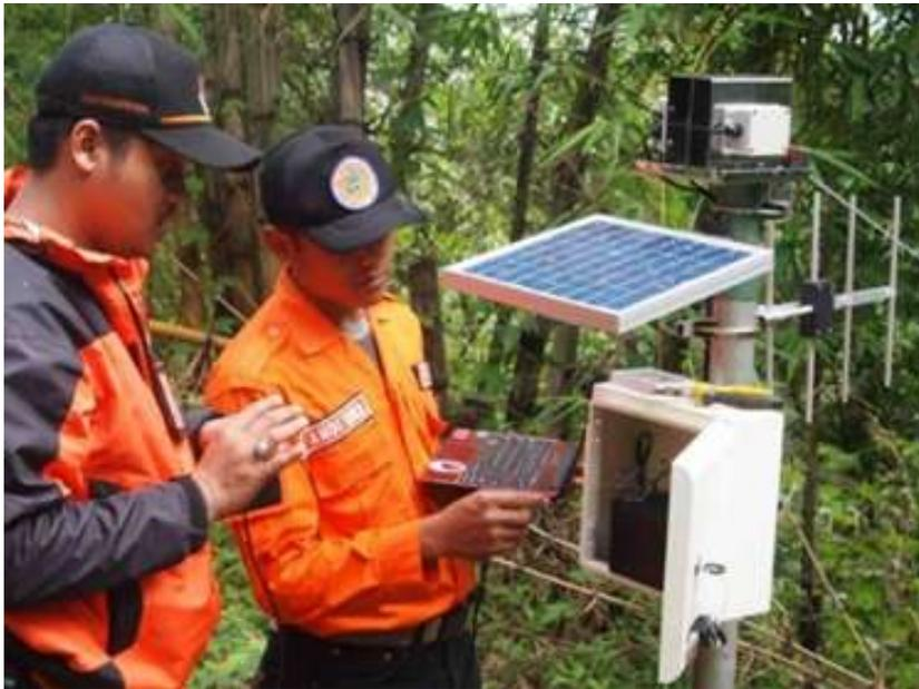
Gambar 112 Proses Pengambilan Data Pada GAMA-EWS yang Telah Terpasang di Salah Satu Daerah Rawan Longsor
