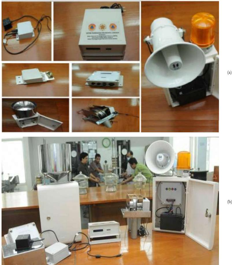
**Gambar 111 (a) Komponen-komponen Perangkat Gama-EWS (b) Pengamatan Ilmiah Alat Pendeteksi Gempa Untuk Menciptakan Varian GAMA-EWS yang Lebih Responsif Terhadap Gempa, Disesuaikan dengan Kondisi di Lapangan**
