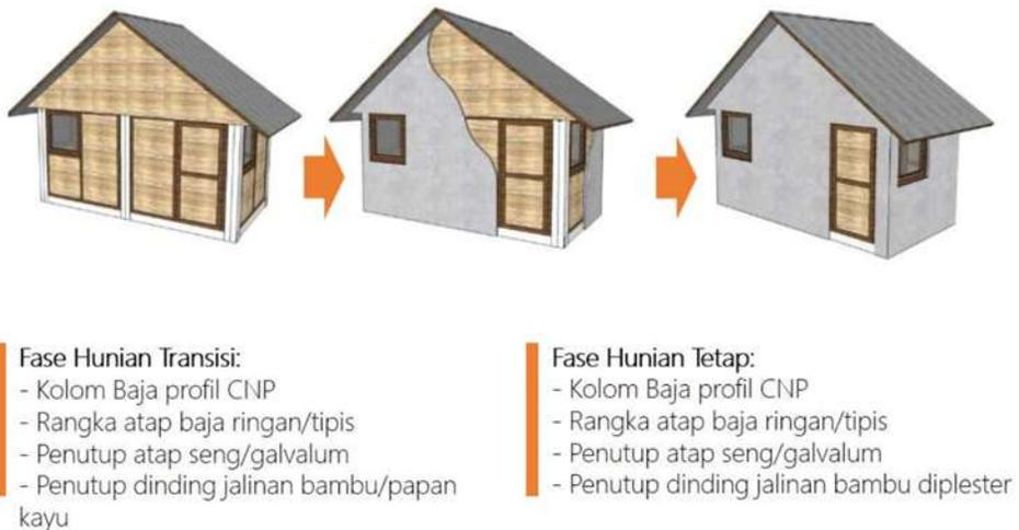
**Gambar 103** Gambaran Proses Pembuatan Hunian Transisi Menuju Permanen di Beberapa Desa di Pulau Lombok
