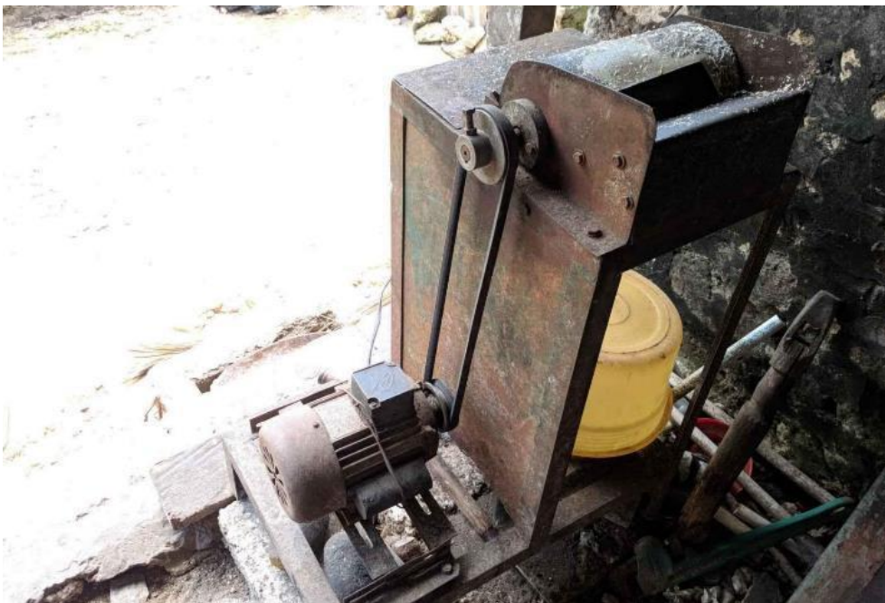
Gambar 5. 5 Mesin pamarut kelapa yang memanfaatkan pompa air listrik sebagai penggerak (Sumber: Dokumentasi Tim UGM, 2019)
